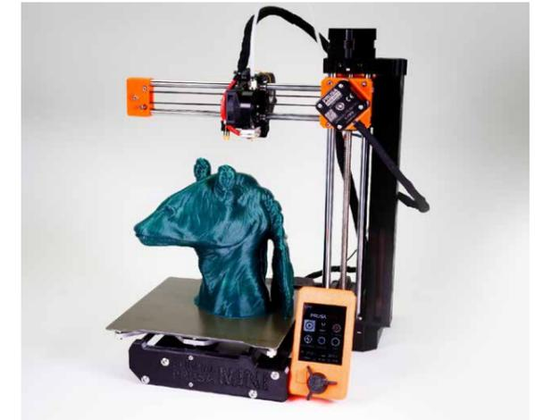
chauffé à haute température, pour fondre et se déposer par couche, pour créer petit à petit notre pièce en 3D.
