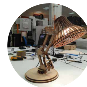
Lampe fabriquée en contreplaqué bois grâce à la découpeuse laser
